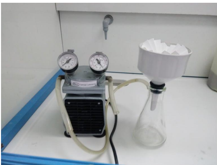
Εικόνα 3.3 Αντλία κενού για διήθηση
